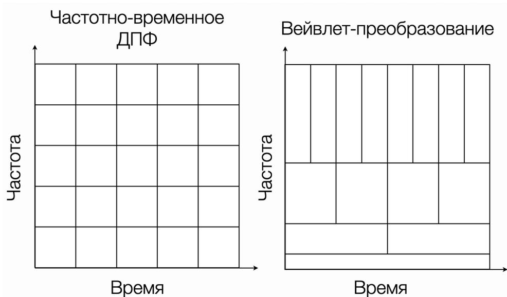
Рис. 4 – Сравнение частотно-временного преобразования Фурье и Вейвлет-преобразования
