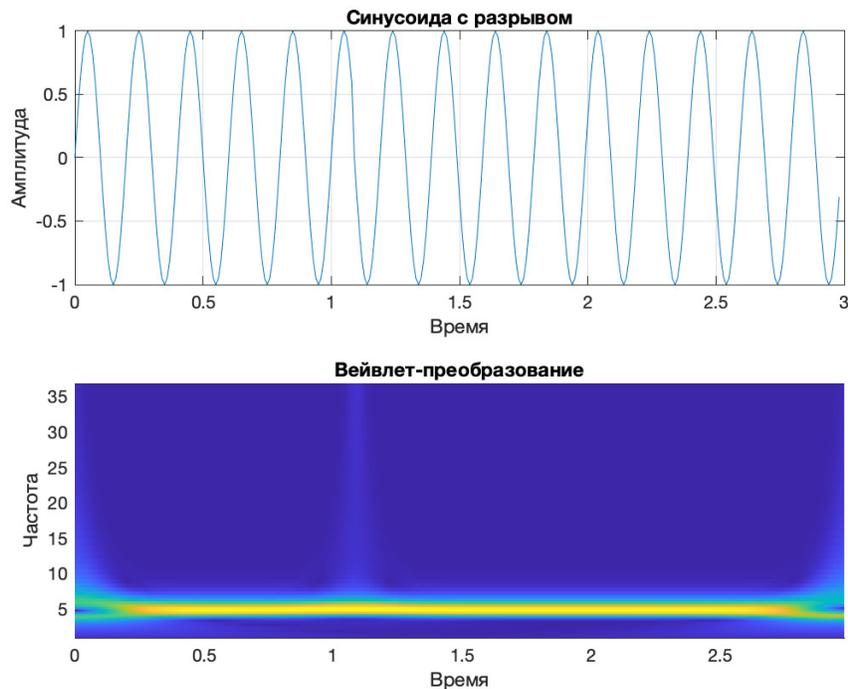
Рис. 9 – Поиск разрыва функции с помощью вейвлет-преобразования
